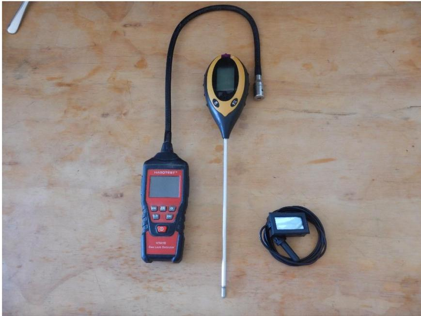
*Equipo para medición de Co2, temperatura y humedad (Fuente propia)*
