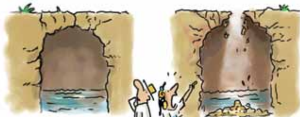
CAVERNA ABOVEDADA CUYO TECHO NO HA CAÍDO.
